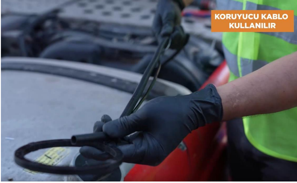
Şekil 12 Kablo Kanalı Kullanımı
