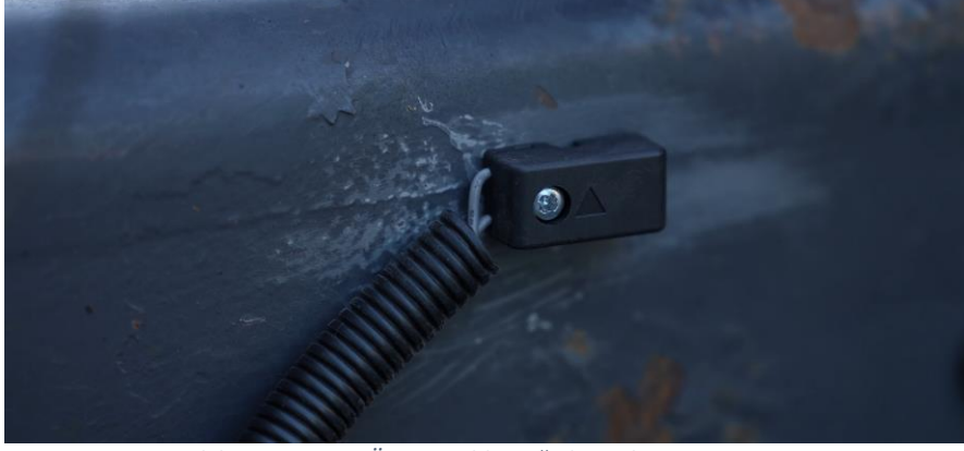
Şekil 15 Yapıştırıcı Öncesi Kablo Bağı ile Toplanmış UTTS Çipi
