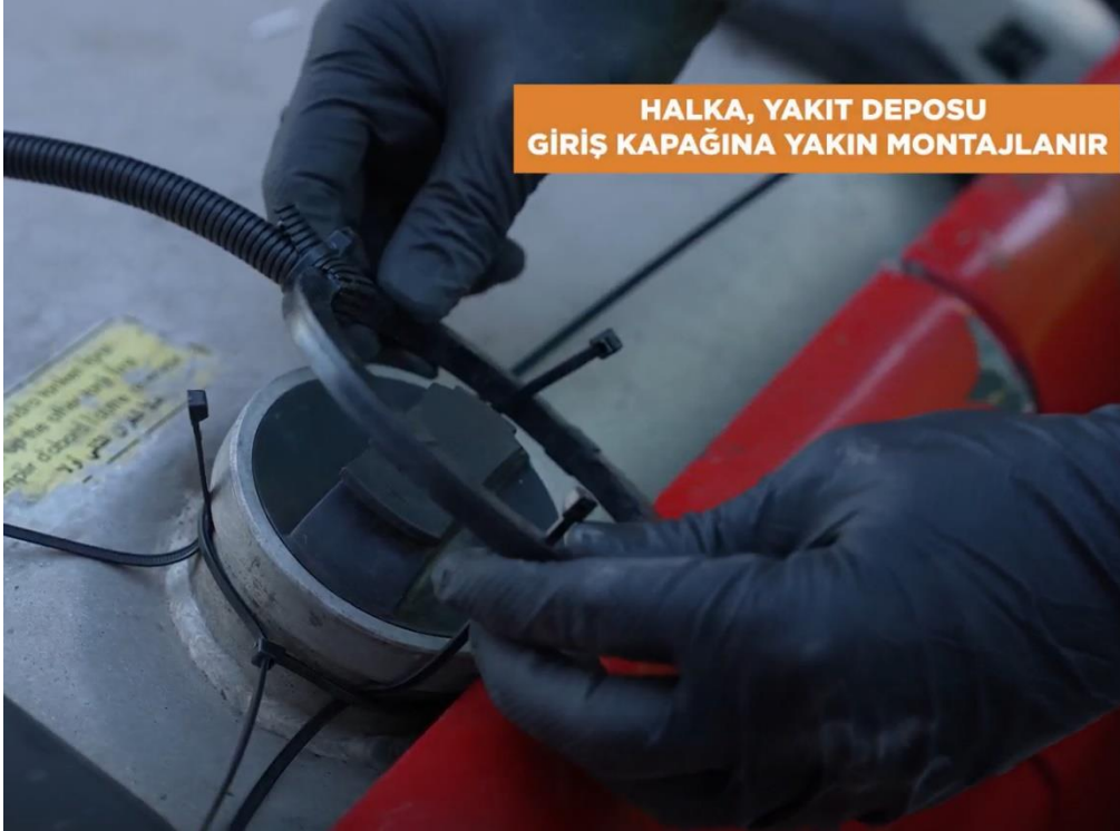
Şekil 13 UTTS Halka Montajı
