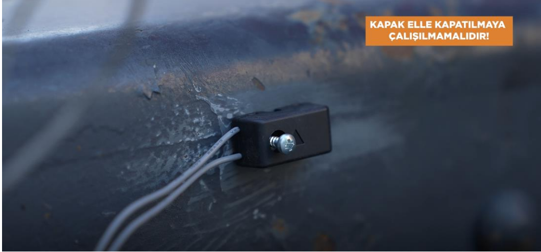
Şekil 8 Tek Taraflı Vida Montajı
