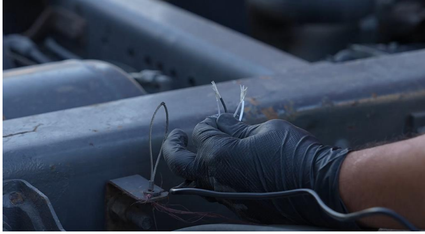
Şekil 10 Anten ve Çip Kablolarının Birleştirilmesi
